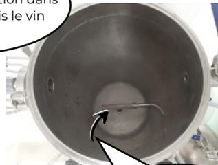
Système d'inertage dans le carter (CO<sub>2</sub> ou azote)
